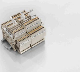
SnapMark - Dieser Schildträger ist speziell für die Doppelstockklemme IDK 1.5N der I-Reihe entwickelt worden. Durch den flexiblen Schwenkmechanismus lassen sich Querverbindungen ohne Aufwand montieren oder entnehmen. Er kann mit vier DEK 5 Bezeichnungsschildern oder zwei WS 10/5 Middle Verbindermarkieren bestückt werden.
