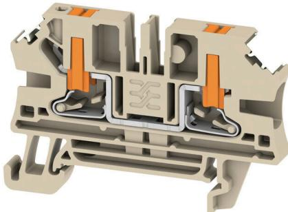
Das Durchführen von Energie, Signalen und Daten ist die klassische Anforderung in der Elektrotechnik und im Schaltschrankbau. Die maßgeblichen Merkmale sind dabei der Isolierstoff, die Anschlusstechnik und der Aufbau der Reihenklemmen. Mithilfe von Durchgangsreihenklemmen können ein oder mehrere Leiter zusammengeführt und/oder angeschlossen werden. Sie können eine oder mehrere Anschlusssebenen haben, die auf dem gleichen Potenzial liegen oder voneinander getrennt sind.
