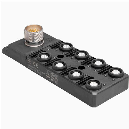
Während im Standard M12 System aufwendig die Drehhülse angeschraubt und durch die Rüttelsicherung behindert wird, funktioniert Push-Pull mit einem Klick, wie die bekannten Wasserschlauchanschlussysteme im Gartenbereich. Die hörbare Verriegelung gewährleistet den sicheren und zuverlässigen Anschluss sowie eine hohe Dichtigkeit. Die neuen SAI-Push-Pull-Verteiler können sowohl zusammen mit M12 Steckverbindern als auch mit den neuen Push-Pull Steckverbindern verwendet werden.
