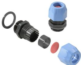
Polyamid-Kabelverschraubungen, welche sich für den Einsatz in explosionsgefährdeten Bereichen Ex e (erhöhte Sicherheit) und Ex i (eigen Sicherheit) eignen. Weidmüller verfügt über eine Produktfamilie ohne Einschränkungen, neben der Normenkonformität besticht die Kabelverschraubung durch eine erhöhte Schlagfestigkeit von 4/7 Joule und einen möglichen Temperaturbereich von bis zu -60°C ohne Einschränkungen.
