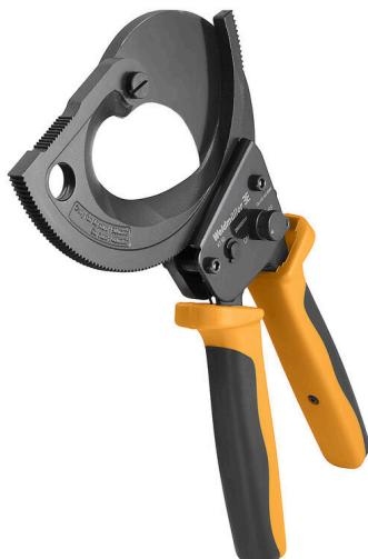
Schneidwerkzeuge in Ratschenausführung. Geeignet zum quetschfreien Schneiden von Kupfer- und Aluminiumleitern. Geringe Handkräfte auf Grund der optimalen Hebelübersetzung und einem technisch ausgereiften Exzenterantrieb.
