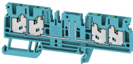
Bei einigen Anwendungen ist ein Prüfabgriff oder ein Trennelement an der Durchgangsklemme für Test- und Sicherheitszwecke sinnvoll. Mit Prüftrennreihenklemmen messen Sie Stromkreise im spannungsfreien Zustand. Während Luft- und Kriechstrecken der Trennstellen nicht maßlich beurteilt werden, muss die angegebene Bemessungsstoßspannungsfestigkeit nachgewiesen werden.
