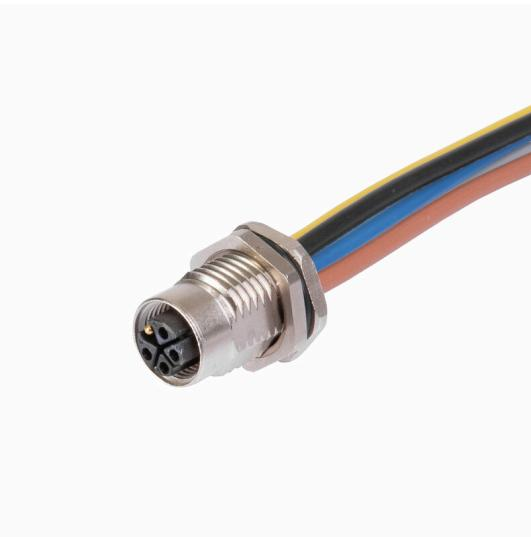
Ihre Geräte in der Peripherie sollen mit großer Leistung versorgt werden. Mit unseren neuen M12-Steckverbindern sind mehr als 250 V und 2 A problemlos möglich. Die kompakten A-, K-, L-, S- und T-codierten M12-Steckverbindern sind auf die Übertragung von bis zu 630 V AC bzw. 60 V DC und 12 A ausgelegt.
