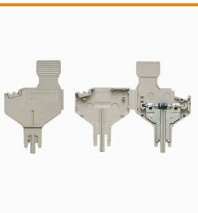
Der Bauelementestecker dient dem integrieren einer elektrischen Komponente in einer Trennreihenklemme. Nach dem Einlöten der jeweiligen Komponente lässt sich der Stecker in den Trennbereich unserer Reihenklemmen integrieren und ändert dadurch die Trennklemme zu einer Reihenklemme mit integrierter elektronischen Komponente.
