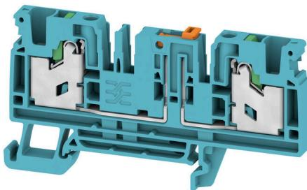
Bei einigen Anwendungen ist ein Prüfabgriff oder ein Trennelement an der Durchgangsklemme für Test- und Sicherheitszwecke sinnvoll. Mit Prüftrennreihenklemmen messen Sie Stromkreise im spannungsfreien Zustand. Während Luft- und Kriechstrecken der Trennstellen nicht maßlich beurteilt werden, muss die angegebene Bemessungsstoßspannungsfestigkeit nachgewiesen werden.
