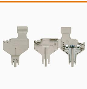
Der Bauelementestecker dient dem integrieren einer elektrischen Komponente in einer Trennreihenklemme. Nach dem Einlöten der jeweiligen Komponente lässt sich der Stecker in den Trennbereich unserer Reihenklemmen integrieren und ändert dadurch die Trennklemme zu einer Reihenklemme mit integrierter elektronischen Komponente.
