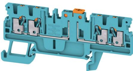
Bei einigen Anwendungen ist ein Prüfabgriff oder ein Trennelement an der Durchgangsklemme für Test- und Sicherheitszwecke sinnvoll. Mit Prüftrennreihenklemmen messen Sie Stromkreise im spannungsfreien Zustand. Während Luft- und Kriechstrecken der Trennstellen nicht maßlich beurteilt werden, muss die angegebene Bemessungsstoßspannungsfestigkeit nachgewiesen werden.
