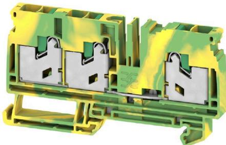
Das Durchführen von Energie, Signalen und Daten ist die klassische Anforderung in der Elektrotechnik und im Schaltschrankbau. Die maßgeblichen Merkmale sind dabei der Isolierstoff, die Anschlusstechnik und der Aufbau der Reihenklemmen. Mithilfe von Durchgangsreihenklemmen können ein oder mehrere Leiter zusammengeführt und/oder angeschlossen werden. Sie können eine oder mehrere Anschlusssebenen haben, die auf dem gleichen Potenzial liegen oder voneinander getrennt sind.
