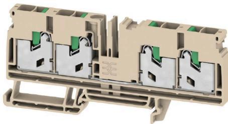
Das Durchführen von Energie, Signalen und Daten ist die klassische Anforderung in der Elektrotechnik und im Schaltschrankbau. Die maßgeblichen Merkmale sind dabei der Isolierstoff, die Anschlusstechnik und der Aufbau der Reihenklemmen. Mithilfe von Durchgangsreihenklemmen können ein oder mehrere Leiter zusammengeführt und/oder angeschlossen werden. Sie können eine oder mehrere Anschlussebenen haben, die auf dem gleichen Potenzial liegen oder voneinander getrennt sind.
