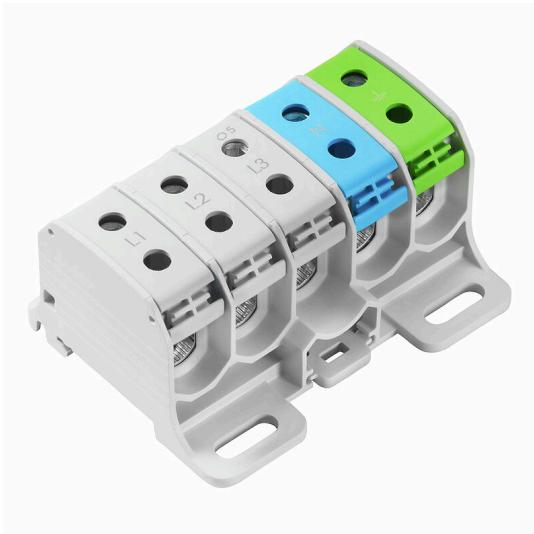
Klippon® Connect-Einspeisereihenklemmen WPD ermöglichen eine einfache und sichere Installation von Aluminium- und Kupferleitern auf engstem Raum. Optional ist auch die Nutzung eines Stromversorgungs- oder Überwachungsanschlusses möglich. Die Einspeisereihenklemmen WPD können unabhängig vom Leiterwerkstoff flexibel eingesetzt werden. Die Montage erfolgt entweder direkt oder auf einer DIN-Tragschiene TS35.
