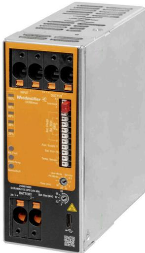
Die USV - Steuereinheit bildet mit dem dazugehörigen Batteriemodul und dem versorgenden Netzteil ein komplettes DC-USV System. Im Normalbetrieb wird die Eingangsspannung von der USV Steuereinheit direkt zur Last durchgeschaltet. Bei Netzausfall (Abfall der DC Eingangsspannung) wird verzögerungsfrei auf Batteriebetrieb umgeschaltet. Bei Netzwiederkehr wird in den Normalbetrieb zurückgeschaltet und die Batterie wird vom integrierten Ladegerät wieder vollgeladen.
