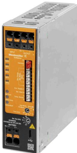
Die USV - Steuereinheit bildet mit dem dazugehörigen Batteriemodul und dem versorgenden Netzteil ein komplettes DC-USV System. Im Normalbetrieb wird die Eingangsspannung von der USV Steuereinheit direkt zur Last durchgeschaltet. Bei Netzausfall (Abfall der DC Eingangsspannung) wird verzögerungsfrei auf Batteriebetrieb umgeschaltet. Bei Netzwiederkehr wird in den Normalbetrieb zurückgeschaltet und die Batterie wird vom integrierten Ladegerät wieder vollgeladen.
