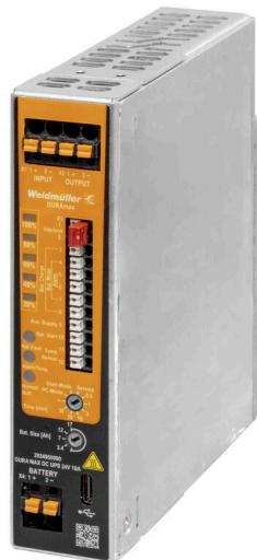
Die USV - Steuereinheit bildet mit dem dazugehörigen Batterimodul und dem versorgenden Netzteil ein komplettes DC-USV System. Im Normalbetrieb wird die Eingangsspannung von der USV Steuereinheit direkt zur Last durchgeschaltet. Bei Netzausfall (Abfall der DC Eingangsspannung) wird verzögerungsfrei auf Batteriebetrieb umgeschaltet. Bei Netzwiederkehr wird in den Normalbetrieb zurückgeschaltet und die Batterie wird vom integrierten Ladegerät wieder vollgeladen.
