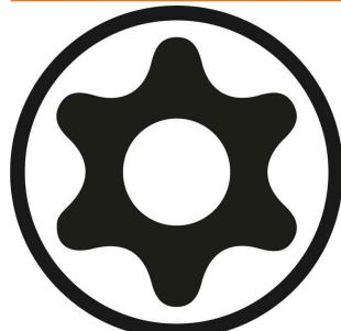
Innensechsrund-Schraubendreher TR mit Bohrung in der Klingenspitze (Tamper Resistant), SD TR zum Verschrauben von Innensechsrund TX und Innensechsrund TR Sicherheitsschrauben (Mittelstift im Profil), Spitze Chrom Top, SoftFinish-Griff
