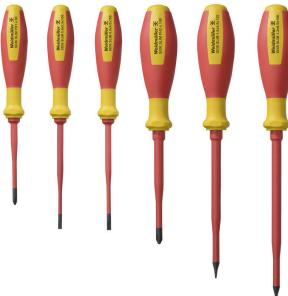
VDE-isolierte Schraubendreher zum Arbeiten an unter Spannung stehenden Teilen bis AC 1000 V und DC 1500 V, DIN EN 60900, IEC 900. Geprüfte Sicherheit GS, stückgeprüft. Klinge aus hochlegiertem Chrom-Vanadium-Molybdän-Stahl, durchgehend gehärtet, brüniert.
