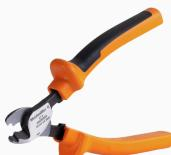
Schneidwerkzeuge für Leiter bis 8 mm, 12 mm, 14 mm bzw. 22 mm Außendurchmesser. Die spezielle Schneidengeometrie ermöglicht ein quetschfreies Schneiden von Kupfer- und Aluminiumleitern mit minimalen Handkräften. Zudem besitzen die Schneidwerkzeuge (KT 8 bis KT 22) VDE- und GS-geprüfte Schutzisolationen bis 1.000 V gemäß EN/IEC 60900.
