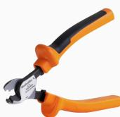
Schneidwerkzeuge für Leiter bis 8 mm, 12 mm, 14 mm bzw. 22 mm Außendurchmesser. Die spezielle Schneidengeometrie ermöglicht ein quetschfreies Schneiden von Kupfer- und Aluminiumleitern mit minimalen Handkräften. Zudem besitzen die Schneidwerkzeuge (KT 8 bis KT 22) VDE- und GS-geprüfte Schutzisolationen bis 1.000 V gemäß EN/IEC 60900.
