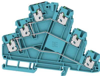
Das Durchführen von Energie, Signalen und Daten ist die klassische Anforderung in der Elektrotechnik und im Schaltschrankbau. Die maßgeblichen Merkmale sind dabei der Isolierstoff, die Anschlusstechnik und der Aufbau der Reihenklemmen. Mithilfe von Durchgangsreihenklemmen können ein oder mehrere Leiter zusammengeführt und/oder angeschlossen werden. Sie können eine oder mehrere Anschlussebenen haben, die auf dem gleichen Potenzial liegen oder voneinander getrennt sind.
