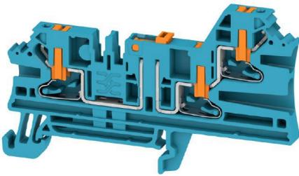
Bei einigen Anwendungen ist ein Prüfabgriff oder ein Trennelement an der Durchgangsklemme für Test- und Sicherheitszwecke sinnvoll. Mit Prüftrennreihenklemmen messen Sie Stromkreise im spannungsfreien Zustand. Während Luft- und Kriechstrecken der Trennstellen nicht maßlich beurteilt werden, muss die angegebene Bemessungsstoßspannungsfestigkeit nachgewiesen werden.
