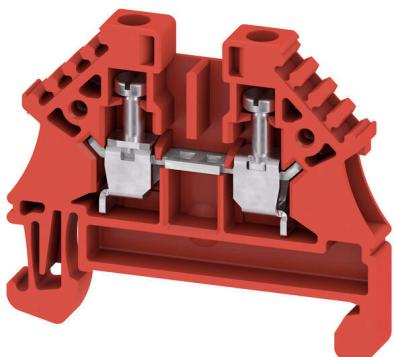
Das Durchführen von Energie, Signalen und Daten ist die klassische Anforderung in der Elektrotechnik und im Schaltschrankbau. Die maßgeblichen Merkmale sind dabei der Isolierstoff, die Anschlusstechnik und der Aufbau der Reihenklemmen. Mithilfe von Durchgangsreihenklemmen können ein oder mehrere Leiter zusammengeführt und/oder angeschlossen werden. Sie können eine oder mehrere Anschlusssebenen haben, die auf dem gleichen Potenzial liegen oder voneinander getrennt sind.
