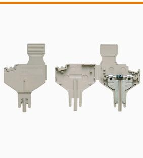
Der Bauelementstecker dient dem integrieren einer elektrischen Komponente in einer Trennreihenklemme. Nach dem Einlöten der jeweiligen Komponente lässt sich der Stecker in den Trennbereich unserer Reihenklemmen integrieren und ändert dadurch die Trennklemme zu einer Reihenklemme mit integrierter elektronischen Komponente.
