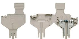
Der Bauelementstecker dient dem integrieren einer elektrischen Komponente in einer Trennreihenklemme. Nach dem Einlöten der jeweiligen Komponente lässt sich der Stecker in den Trennbereich unserer Reihenklemmen integrieren und ändert dadurch die Trennklemme zu einer Reihenklemme mit integrierter elektronischen Komponente.
