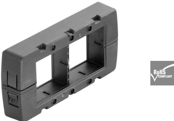
Der aus einem Stück gefertigte, einteilige Rahmen ist schnell und einfach zu montieren und besteht aus formstabilem, glasfaserverstärktem Kunststoff. Die unverlierbare eingeschäumte Dichtung garantiert eine hohe Dichtigkeit von IP66 nach DIN EN 60529, auch an lackierten und rauen Oberflächen.
