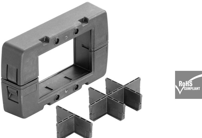
Der aus einem Stück gefertigte, einteilige Rahmen ist schnell und einfach zu montieren und besteht aus formstabilem, glasfaserverstärktem Kunststoff. Die unverlierbare eingeschäumte Dichtung garantiert eine hohe Dichtheit von IP66 nach DIN EN 60529, auch an lackierten und rauen Oberflächen.
