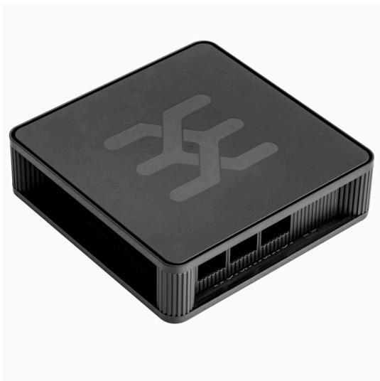
Die u-maker box ist die ideale Grundlage, um mit dem Raspberry Pi eigene Applikationen zu verwirklichen. Das modulare und erweiterbare Gehäuse überzeugt mit vielen Features. Mit dem internen Zubehör können elektronische Komponenten, 3rd-Party-Platinen und weitere Komponenten eingebaut werden. Der externe Halter ist mit einfachem Actioncam-Zubehör kompatibel. So lässt sich die u-maker box flexibel an vielen Stellen befestigen oder mit externem Zubehör ergänzen.
