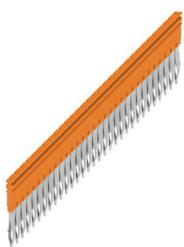
Die Verteilung oder Vervielfältigung eines Potentials auf benachbarte Reihenklemmen wird über eine Querverbindung realisiert. Zusätzlicher Verdrahtungsaufwand lässt sich so einfach vermeiden. Auch bei ausgebrochenen Polen ist weiterhin eine Kontaktsicherheit in den Reihenklemmen gewährleistet. Unser Portfolio bietet steck- und schraubbare Querverbindungssysteme für Reihenklemmen an.
