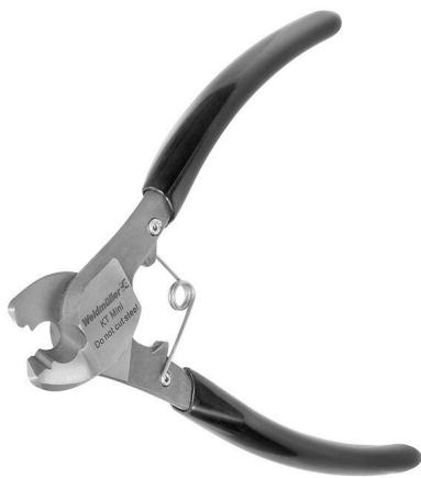
Schneidwerkzeuge für Leiter bis 8 mm, 12 mm, 14 mm bzw. 22 mm Außendurchmesser. Die spezielle Schneidegeometrie ermöglicht ein quetschfreies Schneiden von Kupfer- und Aluminiumleitern mit minimalen Handkräften. Zudem besitzen die Schneidwerkzeuge (KT 8 bis KT 22) VDE- und GS-geprüfte Schutzisolationen bis 1.000 V gemäß EN/IEC 60900.
