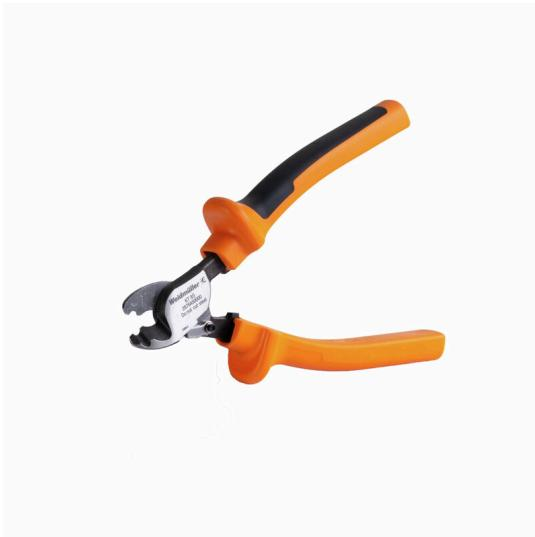
Schneidwerkzeuge für Leiter bis 8 mm, 12 mm, 14 mm bzw. 22 mm Außendurchmesser. Die spezielle Schneidegeometrie ermöglicht ein quetschfreies Schneiden von Kupfer- und Aluminiumleitern mit minimalen Handkräften. Zudem besitzen die Schneidwerkzeuge (KT 8 bis KT 22) VDE- und GS-geprüfte Schutzisolationen bis 1.000 V gemäß EN/IEC 60900.
