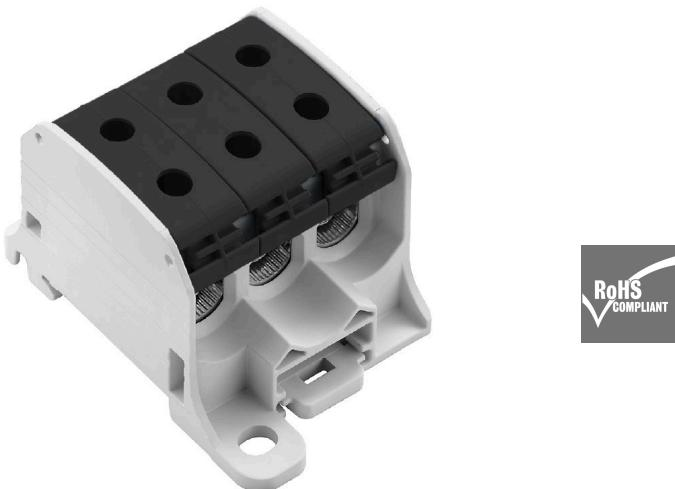
Klippon® Connect-Einspeisereihenklemmen WPD ermöglichen eine einfache und sichere Installation von Aluminium- und Kupferleitern auf engstem Raum. Optional ist auch die Nutzung eines Stromversorgungs- oder Überwachungsanschlusses möglich. Die Einspeisereihenklemmen WPD können unabhängig vom Leiterwerkstoff flexibel eingesetzt werden. Die Montage erfolgt entweder direkt oder auf einer DIN-Tragschiene TS35.
