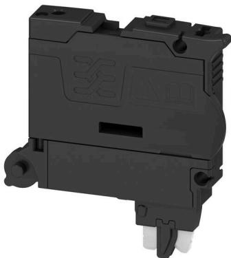
Der Sicherungshalter SIHA macht im Handumdrehen aus einer Trennklemme eine Sicherungsklemme: Einfach den Trennhebel entfernen und den Sicherungsstecker aufstecken.
