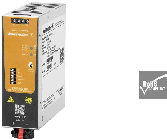
DC/DC-Wandler gleichen Spannungsschwankungen aus, wie sie zum Beispiel bei ungeregelten Spannungsversorgungen oder langen Leitungen entstehen. Mit galvanischer Isolation und Schutzklasse III für erdfreie Systeme ist der DC/DC-Wandler besonders für den Einsatz in unabhängigen Versorgungssystemen geeignet. Das platzsparende Modul kann Spannungsniveaus optimal umwandeln, bietet überdurchschnittliche Leistungsdaten, umfassende Sicherheitsfunktionen und einen hohen Wirkungsgrad von bis zu 95 %.
