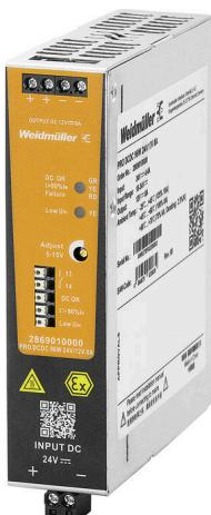
DC/DC-Wandler gleichen Spannungsschwankungen aus, wie sie zum Beispiel bei ungeregelten Spannungsversorgungen oder langen Leitungen entstehen. Mit galvanischer Isolation und Schutzklasse III für erdfreie Systeme ist der DC/DC-Wandler besonders für den Einsatz in unabhängigen Versorgungssystemen geeignet. Das platzsparende Modul kann Spannungsniveaus optimal umwandeln, bietet überdurchschnittliche Leistungsdaten, umfassende Sicherheitsfunktionen und einen hohen Wirkungsgrad von bis zu 95 %.
