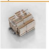
SnapMark - Dieser Schildträger ist speziell für die Doppelstockklemme IDK 1.5N der I-Reihe entwickelt worden. Durch den flexiblen Schwenkmechanismus lassen sich Querverbindungen ohne Aufwand montieren oder entnehmen. Er kann mit vier DEK 5 Bezeichnungsschildern oder zwei WS 10/5 Middle Verbindermarkieren bestückt werden.
