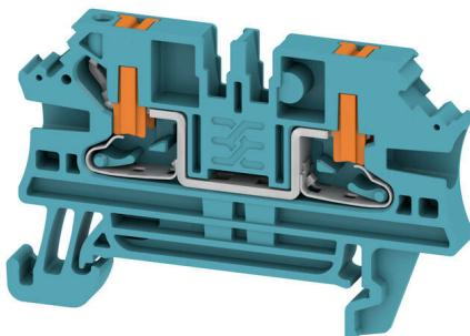
Das Durchführen von Energie, Signalen und Daten ist die klassische Anforderung in der Elektrotechnik und im Schaltschrankbau. Die maßgeblichen Merkmale sind dabei der Isolierstoff, die Anschlusstechnik und der Aufbau der Reihenklemmen. Mithilfe von Durchgangsreihenklemmen können ein oder mehrere Leiter zusammengeführt und/oder angeschlossen werden. Sie können eine oder mehrere Anschlusssebenen haben, die auf dem gleichen Potenzial liegen oder voneinander getrennt sind.
