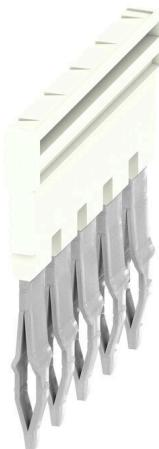
Die Verteilung oder Vervielfältigung eines Potentials auf benachbarte Reihenklemmen wird über eine Querverbindung realisiert. Zusätzlicher Verdrahtungsaufwand lässt sich so einfach vermeiden. Auch bei ausgebrochenen Polen ist weiterhin eine Kontaktsicherheit in den Reihenklemmen gewährleistet. Unser Portfolio bietet steck- und schraubbare Querverbindungssysteme für Reihenklemmen an.
