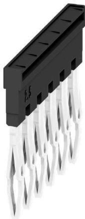
Die Verteilung oder Vervielfältigung eines Potentials auf benachbarte Reihenklemmen wird über eine Querverbindung realisiert. Zusätzlicher Verdrahtungsaufwand lässt sich so einfach vermeiden. Auch bei ausgebrochenen Polen ist weiterhin eine Kontaktsicherheit in den Reihenklemmen gewährleistet. Unser Portfolio bietet steck- und schraubbare Querverbindungssysteme für Reihenklemmen an.
