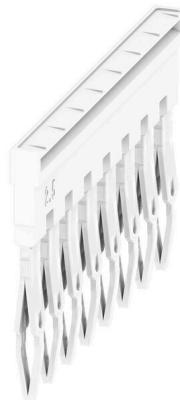
Die Verteilung oder Vervielfältigung eines Potentials auf benachbarte Reihenklemmen wird über eine Querverbindung realisiert. Zusätzlicher Verdrahtungsaufwand lässt sich so einfach vermeiden. Auch bei ausgebrochenen Polen ist weiterhin eine Kontaktsicherheit in den Reihenklemmen gewährleistet. Unser Portfolio bietet steck- und schraubbare Querverbindungssysteme für Reihenklemmen an.
