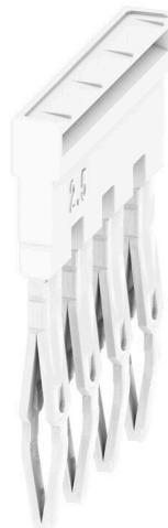
Die Verteilung oder Vervielfältigung eines Potentials auf benachbarte Reihenklemmen wird über eine Querverbindung realisiert. Zusätzlicher Verdrahtungsaufwand lässt sich so einfach vermeiden. Auch bei ausgebrochenen Polen ist weiterhin eine Kontaktsicherheit in den Reihenklemmen gewährleistet. Unser Portfolio bietet steck- und schraubbare Querverbindungssysteme für Reihenklemmen an.
