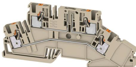
Bei einigen Anwendungen ist ein Prüfabgriff oder ein Trennelement an der Durchgangsklemme für Test- und Sicherheitszwecke sinnvoll. Mit Prüftrennreihenklemmen messen Sie Stromkreise im spannungsfreien Zustand. Während Luft- und Kriechstrecken der Trennstellen nicht maßlich beurteilt werden, muss die angegebene Bemessungsstoßspannungsfestigkeit nachgewiesen werden.
