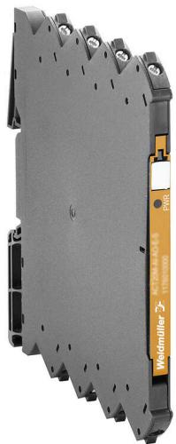
Der softwarekonfigurierbare universelle Frequenz Messumformer trennt und wandelt Eingangssignale (Frequenz, Namur, NPN, PNP, Tacho, TTL und S0) in ein aktives analoges Standard-Ausgangssignal. Die Spannungsversorgung ist galvanisch von Ein- und Ausgang getrennt (3-Wege-Trennung) und erfolgt über eine Direktverdrahtung. Das Modell ACT20M-FRQ-AO-S kann über den Weidmüller-Tragschienenbus versorgt werden.
