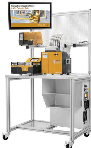
Kabel automatisch und mit höchster Flexibilität konfektionieren – Wire Processing Center (WPC)
