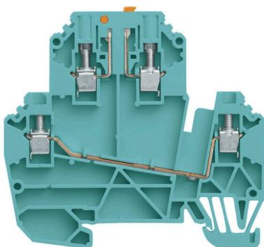
Bei einigen Anwendungen ist ein Prüfabgriff oder ein Trennelement an der Durchgangsklemme für Test- und Sicherheitszwecke sinnvoll. Mit Prüftrennreihenklemmen messen Sie Stromkreise im spannungsfreien Zustand. Während Luft- und Kriechstrecken der Trennstellen nicht maßlich beurteilt werden, muss die angegebene Bemessungsstoßspannungsfestigkeit nachgewiesen werden.
