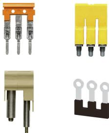
Die Verteilung oder Vervielfältigung eines Potentials auf benachbarte Reihenklemmen wird über eine Querverbindung realisiert. Zusätzlicher Verdrahtungsaufwand lässt sich so einfach vermeiden. Auch bei ausgebrochenen Polen ist weiterhin eine Kontaktsicherheit in den Reihenklemmen gewährleistet. Unser Portfolio bietet steck- und schraubbare Querverbindungssysteme für Reihenklemmen an.
