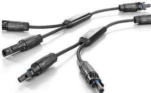
Das Y-Kabel wird zur Parallelverbindung von mehreren Strings einer PV-Anlage verwendet, z.B. zur Aufspaltung einer Leitung vor einem Wechselrichter. Die Kabel gibt es in verschiedenen Anschlussvarianten.
