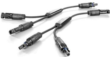
Das Y-Kabel wird zur Parallelverbindung von mehreren Strings einer PV-Anlage verwendet, z.B. zur Aufspaltung einer Leitung vor einem Wechselrichter.
