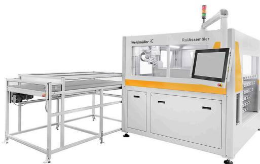
Der Klippon® Automated RailAssembler ermöglicht die vollautomatische Bestückung von Klemmleisten. In Kombination mit dem Weidmüller Configurator (WMC) erspart der Einsatz des Automaten das Kommissionieren, Zuordnen und Positionieren der einzelnen Klemmen im Produktionsprozess. So kann bei der regulären Bestückung eine Zeiteinsparung von bis zu 60 Prozent erreicht werden. Im mannlosen Betrieb lässt sich der Wert sogar noch deutlich erhöhen.
