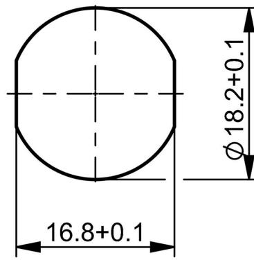
B Durchgangsbohrung mit Verdrehschutz
