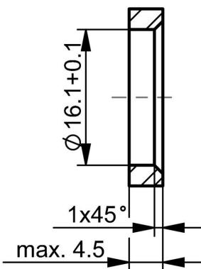
A Durchgangsbohrung ohne Verdrehschutz
