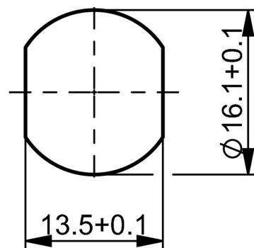
A Durchgangsbohrung mit Verdrehschutz
